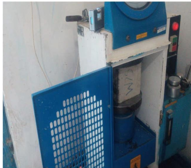
شکل ۲- نحوه شکستن نمونه ها با جک دیجیتال
