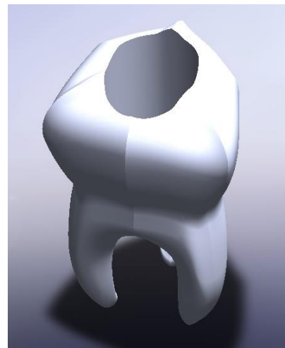
شکل ۱: مدل دندان مولر طراحی شده در محیط سالیدورکس با در نظر گرفتن کانال اکسس
